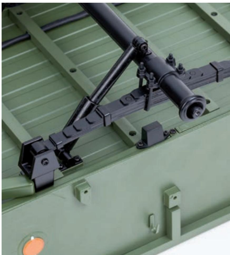
**Шаг 5.** Закрепите ранее снятый буфер рессоры на полу прицепа. Для фиксации детали используйте два винта 1,7×4 (СМ).
