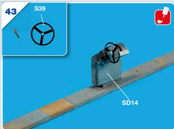
Выньте рулевое колесо **S39** из фототравленного листа, нанесите грунтровку и покрасьте его в черный цвет. Отрежьте кусочек небольшого гвоздя и покрасьте его в цвет алюминия. Когда краска высохнет, вставьте гвоздь в отверстие рулевого колеса и прикрепите его к детали **SD14**.
