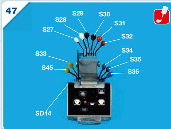
Сверьтесь с этой фотографией, чтобы правильно выставить позиционирование и угол наклона каждого рычага управления. Вырежьте небольшую панель приборов с предварительно напечатанной карты и приклейте ее на деталь **SD14** как показано на фотографии.
