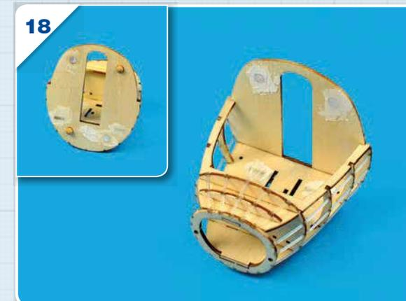
С помощью шпаклевки для моделирования тщательно обработайте любые щели между установленными деталями.
