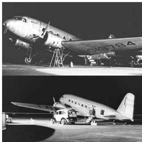
Две фотографии одного и того же DC-2 от "TWA" на обслуживании в Окленде. Заметное сзади (нижний рисунок) - устройство для крепления груза или багажа, в данном случае оно используется для закладки мешков с почтой.
