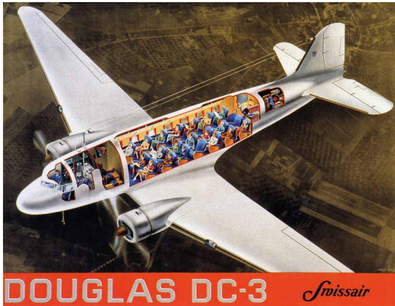
Внутри DC-3: Макет с 21 местом, показанный на рекламном плакате "Swissair". Хотя пропорции были немного изменены, чтобы подчеркнуть впечатление пространства, иллюстрация наглядно показывает не только пассажирский салон, но и багажное пространство как спереди, так и сзади, радиоотсек за кабиной пилота и кухню в задней части самолета. В этом случае, посадочная дверь также находится справа.
