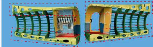
Сгладьте зоны контакта между двумя половинами каркаса наждачной бумагой (пунктирные красные линии).
