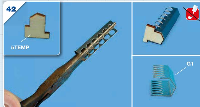
Выньте деталь G1 из фототравленного листа, отшлифуйте любые неровности и согните деталь парой плоскогубцев как показано на фотографии, используя деталь 5TEMP, вырезанную лазером из фанеры, как шаблон таким образом, чтобы она приняла правильную форму.
