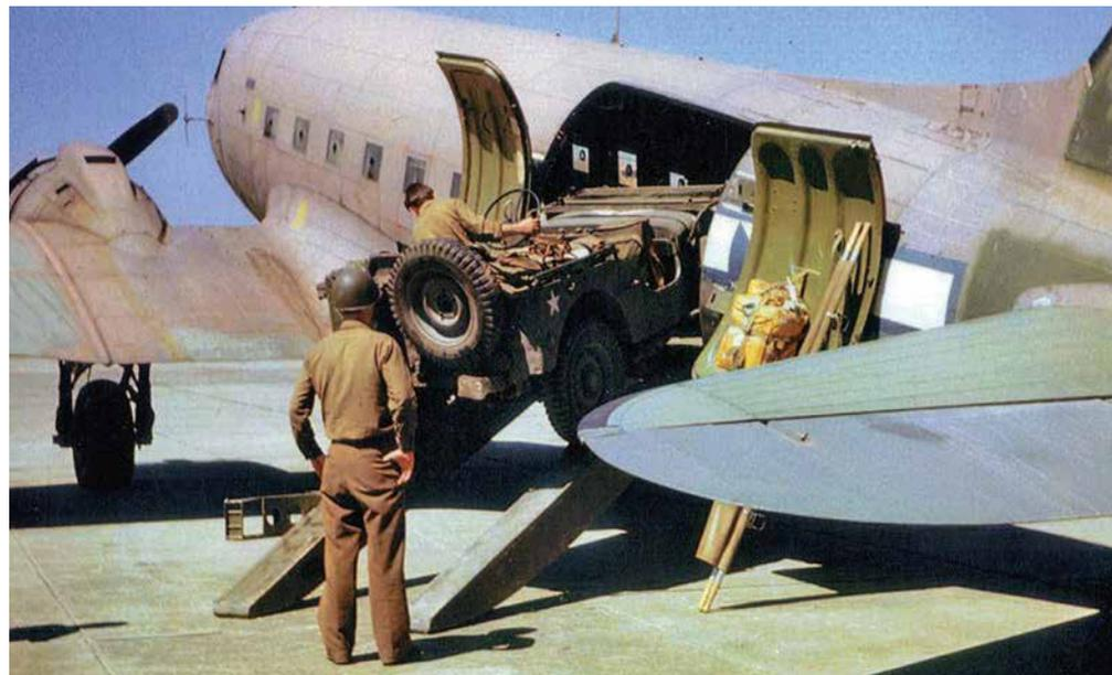
Следуя спецификациям, основное пространство C-47 должно было в состоянии вместить джип с прицепом или 37 мм противотанковой пушкой; угол наклона пола в задней части отсека был спроектирован таким образом, чтобы облегчить перемещение груза. Когда пассажиров не было, то места, которые вы видели на двух предыдущих снимках, можно было сложить таким образом, чтобы использовать всю ширину пола в отсеке.
