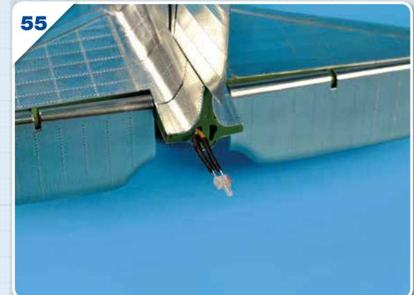
55 Тем же способом, которым вы установили светодиоды в крылья, установите белый светодиод в задней части хвоста (см. фотографию).
