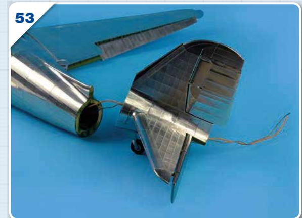
53 Протяните провода через хвост, используя тонкий металлический стержень, чтобы вынуть их из конца. Этот процесс объясняется в Наборе 9.
