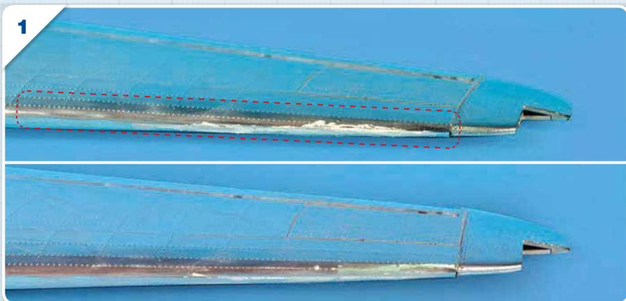
1 Возьмите крылья самолета. Выровняйте и обработайте наждачной бумагой все дефекты между верхней и нижней деталями обшивки передних краев
