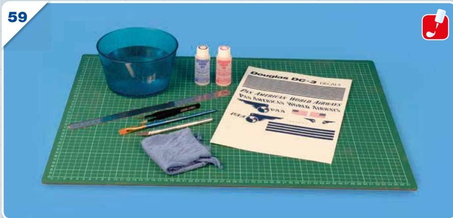
Чтобы приклеить переводные наклейки, вам понадобится миска с водой, металлическая линейка, пинцет с закругленными концами, плоская кисть, отделочный нож с новым и очень острым лезвием, безворсовая ткань, впитывающая ткань и специальные жидкости для приклеивания переводных наклеек. Эти жидкости продаются в любом магазине для моделирования или магазине «сделай сам».
