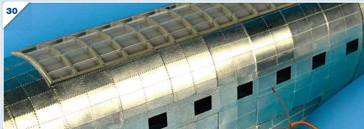
На фотографии изображена установленная деталь потолка – обработайте часть наждачной бумагой, чтобы она точно входила в отверстие. Помните, что деталь будет обшиваться алюминием; обшивка должна быть на одном уровне с обшивкой окружающих деталей
