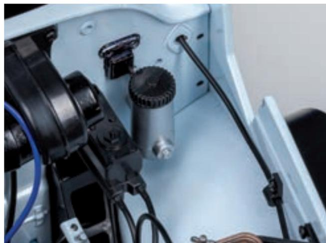
Протяните свободный конец провода датчика перегрева двигателя сквозь фиксатор, установленный на вертикальной плоскости левого брызговика двигателя позади кронштейна крепления аккумулятора. Далее закрепите провод в отверстии перегородки моторного отсека.
