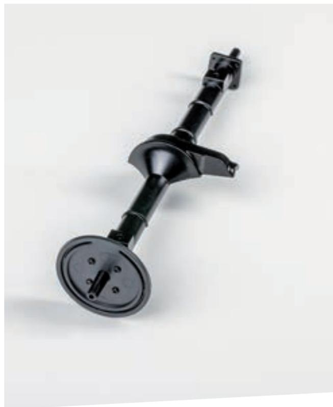
Установите левый щит заднего тормоза на левой полуоси заднего моста. Совместите центrovочный штифт крепежного фланца полуоси с ответным пазом на щите. Закрепите деталь при помощи четырех винтов 1,7×4 (AM) с внешней стороны тормозного щита.
