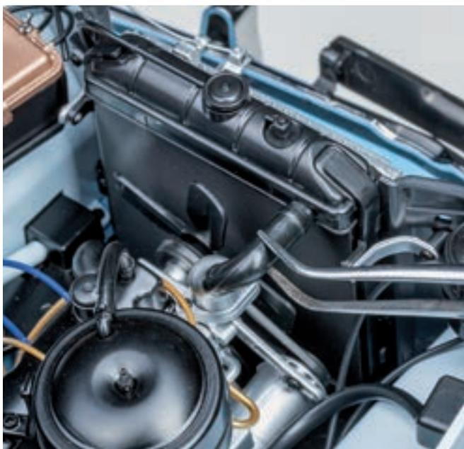
Подсоедините верхний и нижний патрубки к корпусу радиатора. При необходимости зафиксируйте детали клеем. Закрепите радиатор с нижней стороны шасси модели двумя винтами 1,7×4 (AP).
