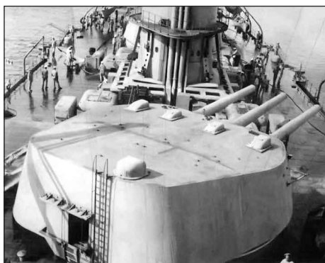
Третья башня линкора «Полтава», 1915 – 1916 гг. Поручни трапа с закругленными передней и задней частями на задней стенке башни
